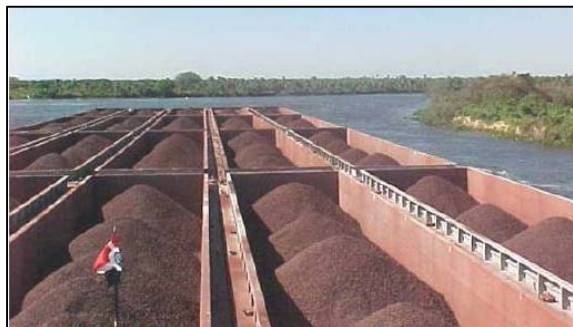
Figura 8 – Comboio 4x5 homologado pela Marinha no trecho Corumbá-Assunção. Fonte: VALE (2009).
