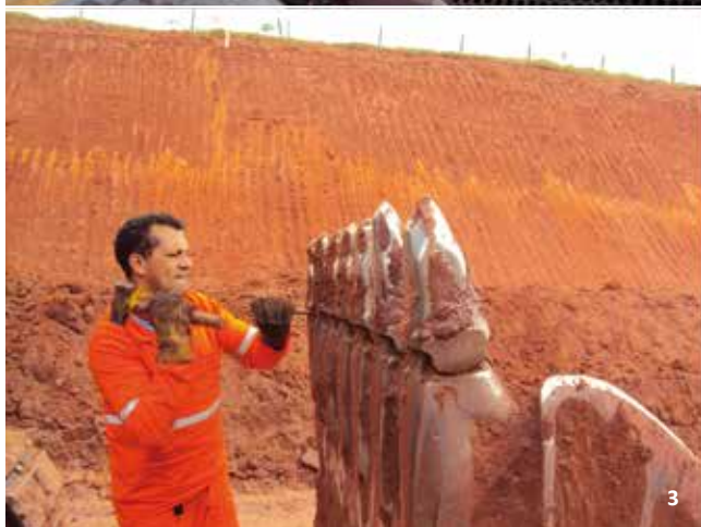
1 e 2. Manutenção do sistema de exaustão do rolo compactador liso | 3. Manutenção da concha da escavadeira | 4. Serviços gerais em rolo compactador.
