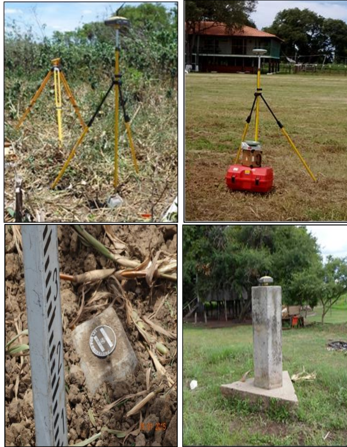
FIGURA 19 - EQUIPAMENTOS UTILIZADOS PARA IMPLANTAÇÃO DAS RRNN. (A) CONJUNTO NÍVEL TOPOGRÁFICO E EQUIPAMENTOS GNSS; (B) RECEPTOR GNSS; (C) RÉGUA ESTADIMÉTRICA E (D) RECEPTOR GNSS.
