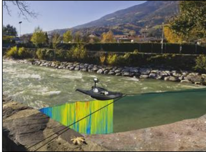
FIGURA 35 - DIAGRAMA DE UMA EMBARCAÇÃO REALIZANDO MEDIÇÕES DE ADCP EM UMA SEÇÃO TRANSVERSAL DE UM CANAL.
