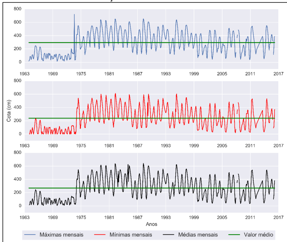
FIGURA 29 - COTAS A) MÉDIAS, B) MÁXIMAS E C) MÍNIMAS DA ESTAÇÃO FLUVIOMÉTRICA DE PORTO ESPERANÇA PARA O PERÍODO DE 1963 A 2015.
