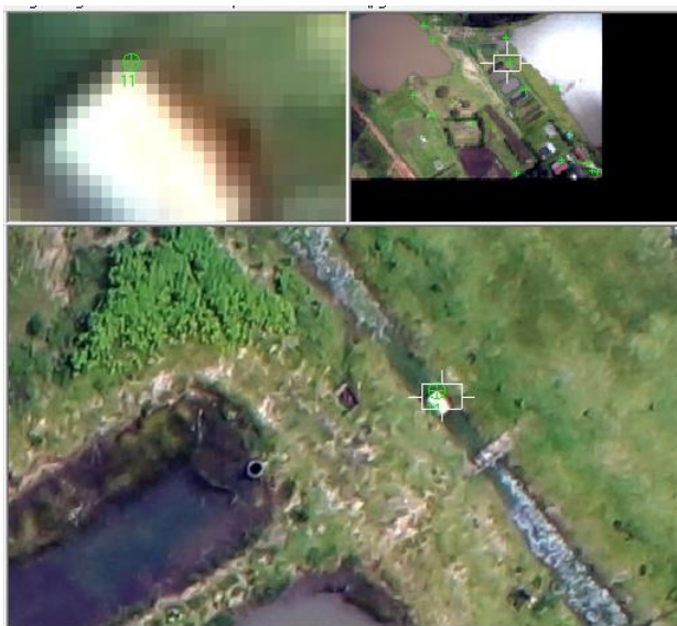
FIGURA 8: Foto identificação do ponto de controle no LPS (Fonte: Autor 2013)
